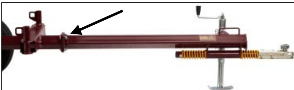
6. Installez le grillage (ou le support de mât de déversement si "ensemble de route") sur la pôle avant assemblée avec les deux (2) boulons carrosserie 1/2-13 x 4 et les deux (2) écrous 1/2-13 à environ **30 cm (12")** du joint d'assemblage.
