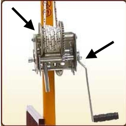
1. Fixez le treuil manuel au mât de chargement avec les deux (2) boulons 3/8-16 x 2 1/2 et les deux (2) écrous 3/8-16. Fixez ensuite la poignée du treuil au treuil à l'aide de l'écrou (1) prévu à cet effet.
