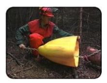
4. Installer le déclencheur automatique sur le câble à l'endroit voulu pour le déclenchement.
