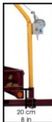
2. Installez le mât de chargement (photo 1) ou le mât de déchargement (photo 2) parallèlement à la remorque.
