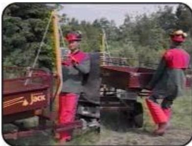
6. Finalement, retirez les supports de boîte avant et arrière situés sur la base de la remorque. Insérez les poteaux à bois dans les quatre (4) tubes ronds prévues à cet effet. Assurez-vous d'aligner les crochets sur les poteaux avec ceux situés sur les supports à poteaux (tubes ronds). Ensuite, insérez le pivot et le mât de chargement dans leurs emplacements sur la base du grillage (position de transport).
