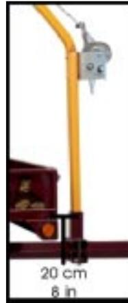
3. Installez le bras d'extension de déchargement au haut du mât de chargement en soulevant la poulie pivotante, insérant le bras d'extension et réinsérant la poulie dans le tube du mât. Insérez le câble dans la poulie avant du bras d'extension. (s'applique seulement pour le mât de chargement illustré ci-dessous).
