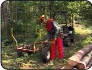
2. Soulevez un bout du billot et déposez le sur le trident du pivot (approximativement 1/3 de sa longueur).
