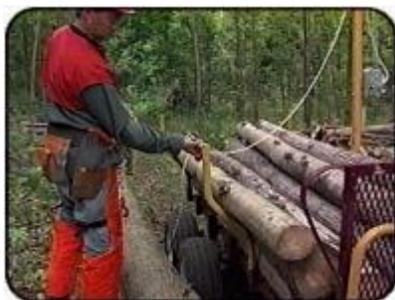
3. Ensuite, attachez le câble du mât de chargement au centre de la chaîne en "V". Notez que le câble doit passer sous le billot avant d'être attaché à la chaîne en "V".
