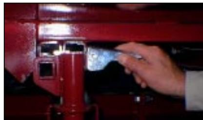
4. Insérez ensuite le mât de chargement en position de transport, la poignée du treuil vers la voiture et attachez le câble au grillage pour retenir le mât à l'aide du treuil.
